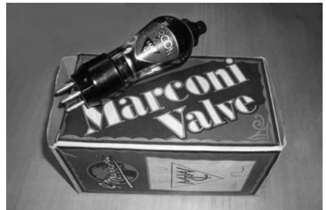
Fig. 3. Foto di una valvola termoionica costruita nello stabilimento di Chelmsford (Londra), fondata da Marconi nel 1897. La valvola termoionica è simile a una lampada ad incandescenza (all'interno della quale viene fatto il vuoto) con due elettrodi che, attraversati dalla corrente, consentono di modulare le onde elettromagnetiche per riprodurre la voce umana e la musica (foto di Paolo Michelini nel Museo Marconi di Villa Griffone a Pontecchio).
