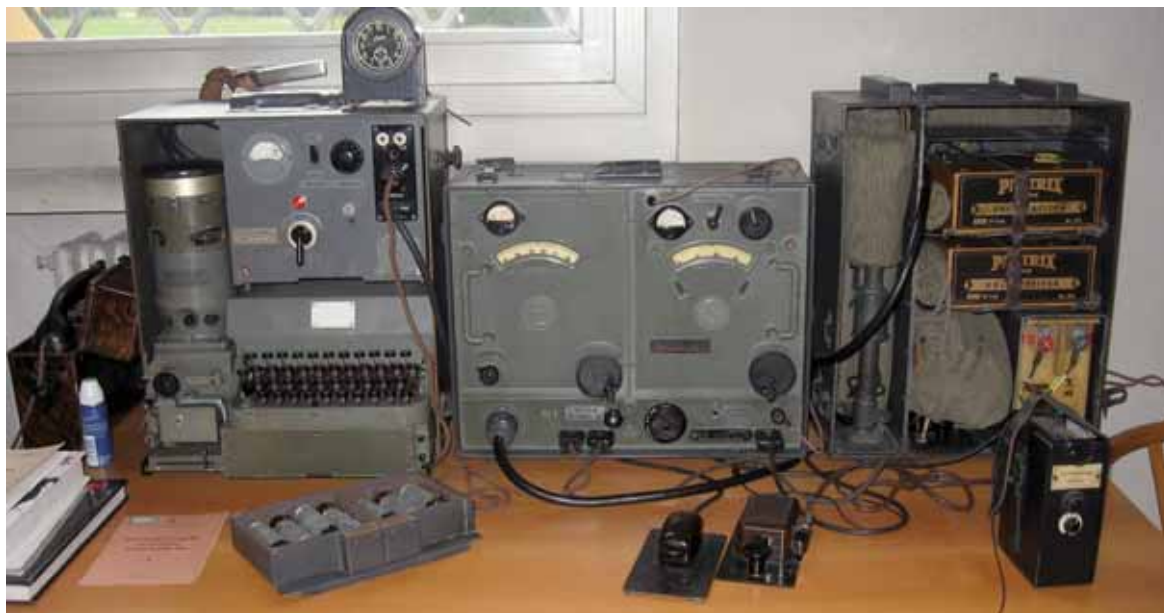
Fig. 9. Stazione radio telescrivente portatile di costruzione tedesca, anno 1944, impiegata durante il secondo conflitto mondiale. La parte sinistra è la stampante, la parte centrale il ricetrasmittitore radio, la parte di destra è di alimentazione (Collezione Maurizio Bigazzi, Museo Marconi; foto Francesco Bergamaschi)
