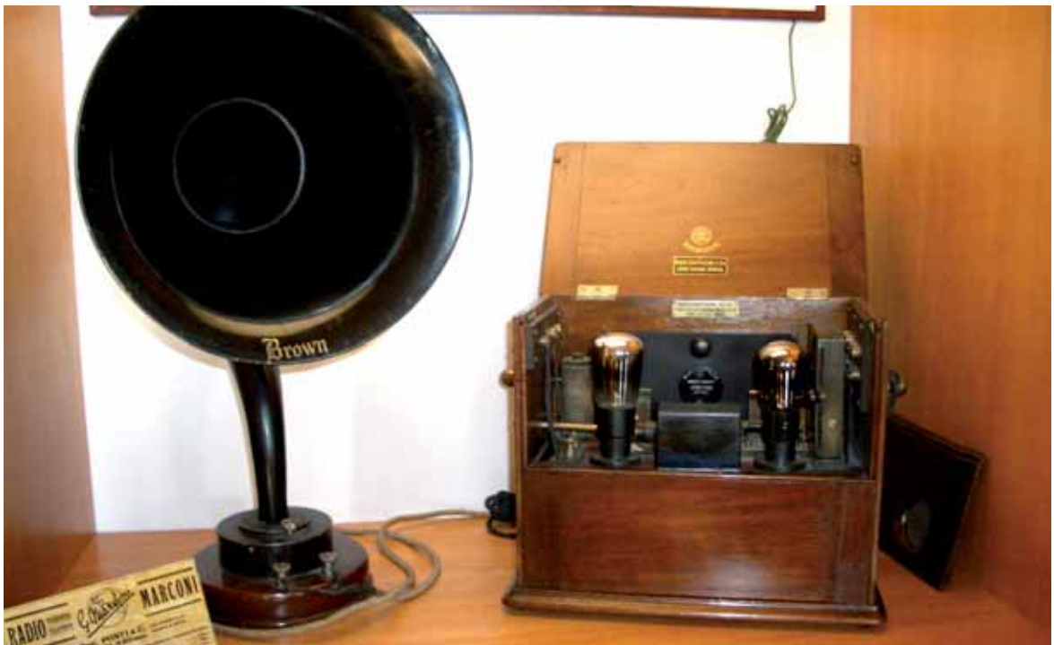
Fig. 6. Apparecchio radiorecettore a valvole costruito dalla fabbrica inglese della Compagnia Marconi nel 1922 (Collezione Maurizio Bigazzi, Museo Marconi; foto Paolo Michelini)
