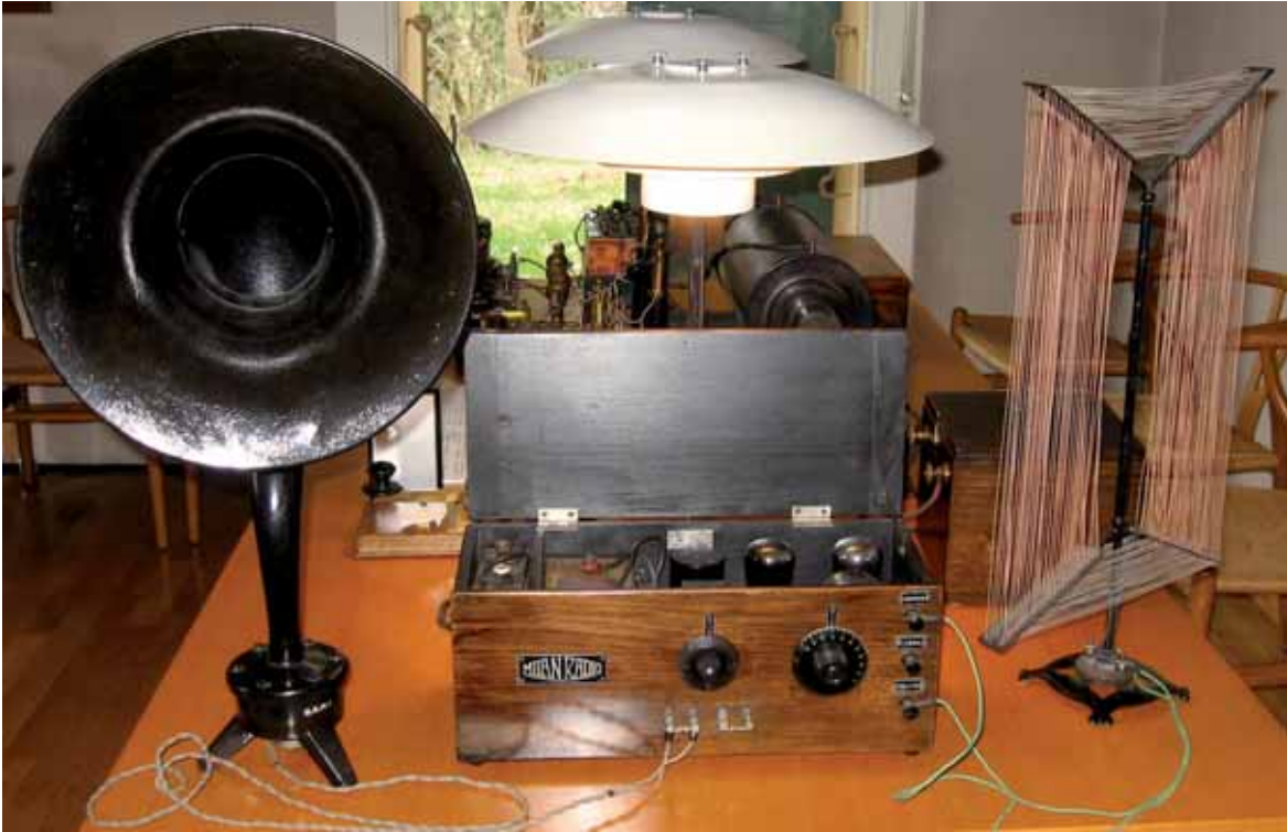
Fig. 7. Uno dei primi apparecchi radiorecettori a valvole di costruzione italiana, della MilanRadio, anno 1925 (Collezione Maurizio Bigazzi, Museo Marconi; foto Francesco Bergamaschi)
