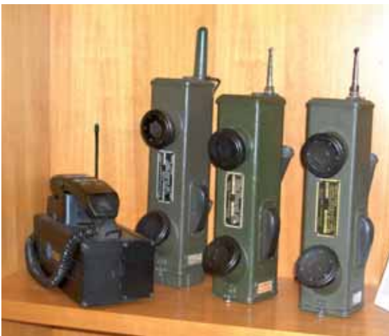
Fig. 8. Apparecchi radio ricetrasmittenti portatili di costruzione americana impiegati nella seconda guerra mondiale (ed in particolare durante lo sbarco in Normandia): furono gli antenati dei moderni telefoni cellulari (Collezione Maurizio Bigazzi, Museo Marconi; foto Paolo Michelini)
