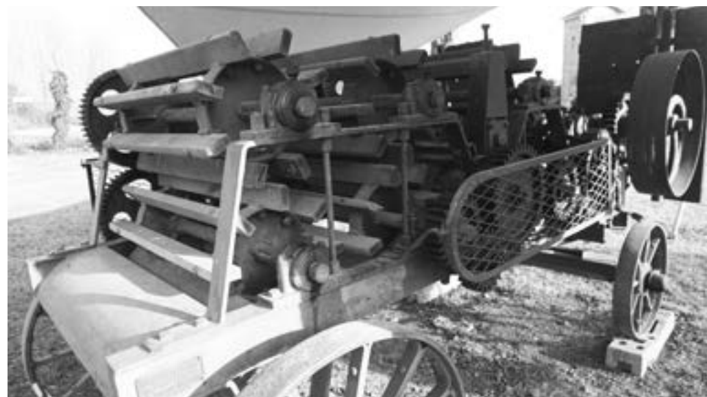
Fig.15. Scavezzatrice meccanica (cilindro) esposta al Museo della Civiltà Contadina di San Marino di Bentivoglio (foto Mauro Filippini).
