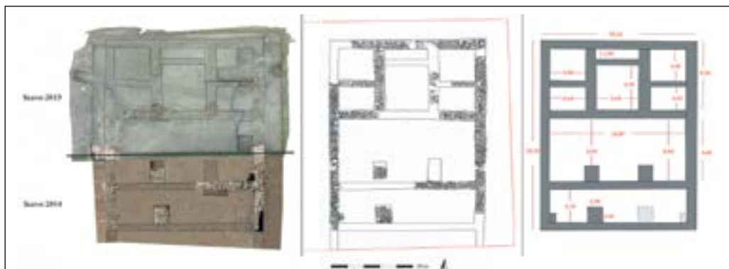
Fig.9. Planimetria del tempio di uni; da sinistra: rilievo fotogrammetrico, rilievo vettoriale, schema della planimetria.
