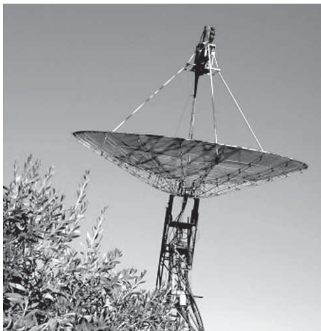
Fig. 5. Antenna parabolica EME (Earth Moon Earth, ossia: Terra Luna Terra) installata presso una stazione radioamatoriale in Sudafrica, che consente comunicazioni a grande distanza fra due punti della Terra facendo rimbalzare le onde sulla superficie della luna (foto tratta dal sito www.qsl.net )
