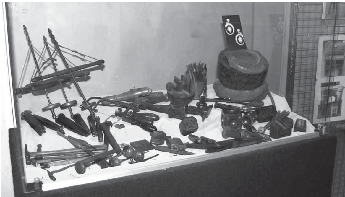
Fig. 5. Attrezzi vari da banco (archetti, trapani, spine, spiana cerniere, misura fili, compassi, cesoia, morsetti, martelli, bornitori e tanaglioli), stampi della scuola Castellani (Roma) e strumenti per sbalzo e cesello (boccia, incudine, tasso, bulini, bottoniere e imbottitore) (foto di Gian Lorenzo Calzoni)
