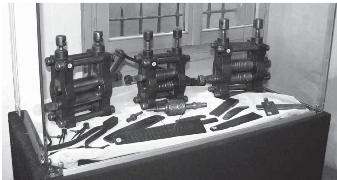
Fig. 8. Tre tipologie di laminatoi (a lastra, a mezzotondo e a filo), rullo godronato, trafile e tenaglia (foto di Gian Lorenzo Calzoni)
