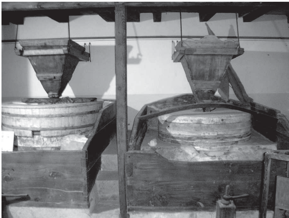
Fig. 4. Macine con le relative tramogge. In quella di sinistra le macine sono circondate dalla "cascina" in legno con al centro il foro per la fuoruscita della farina. In quella di destra si vede, dal basso, il "regolatore" a vite con cui si regolava la finezza della farina, la vasca di legno per la raccolta della farina, detta "palmento", la macina fissa murata nel basamento e quella mobile (foto Silvano Bonaiuti)
