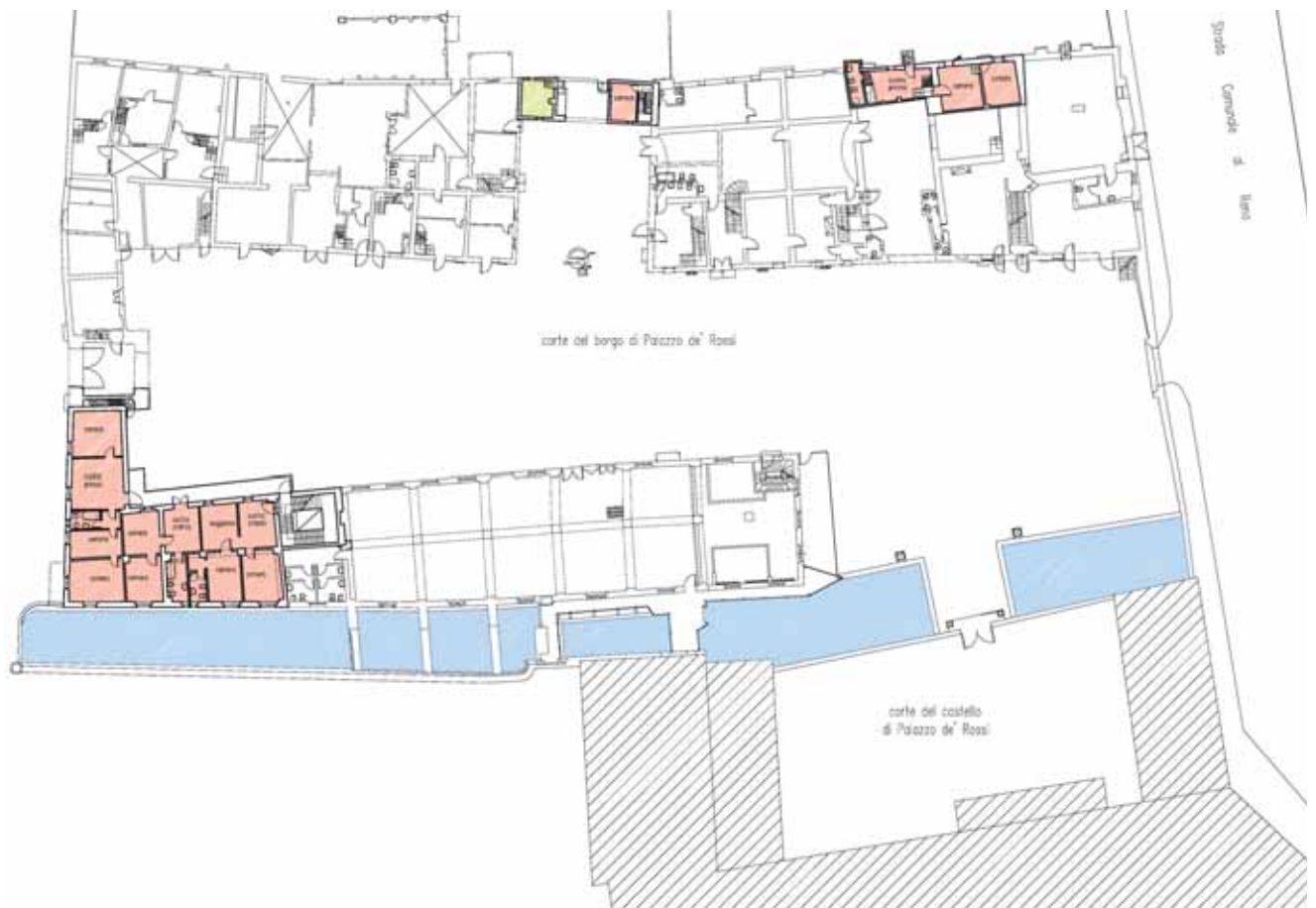
Fig. 9. Pianta Piano Ammezzato, dove si nota l'innestarsi del nuovo piano adibito ad abitazione, tra i due esistenti con accesso dal ballatoio, e l'adeguamento igienico sanitario effettuato in epoca più recente. Tavola rappresentante le destinazioni d'uso attuali del Piano Ammezzato. Elaborato grafico originale in scala 1:200, rilievo anno 1999/2000 (di Sabrina Carlini e Michaela D'Astuto).
